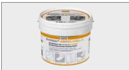
Schlüter®-KERDI-COLL-L je dvousložkové těsnicí lepidlo na bázi akrylátové disperze (bez rozpouštědel) a cementového reaktivního prášku. Je vhodné pro lepení a utěsnění spojů pásů Schlüter®-KERDI překlátováním a spojů na sraz.
