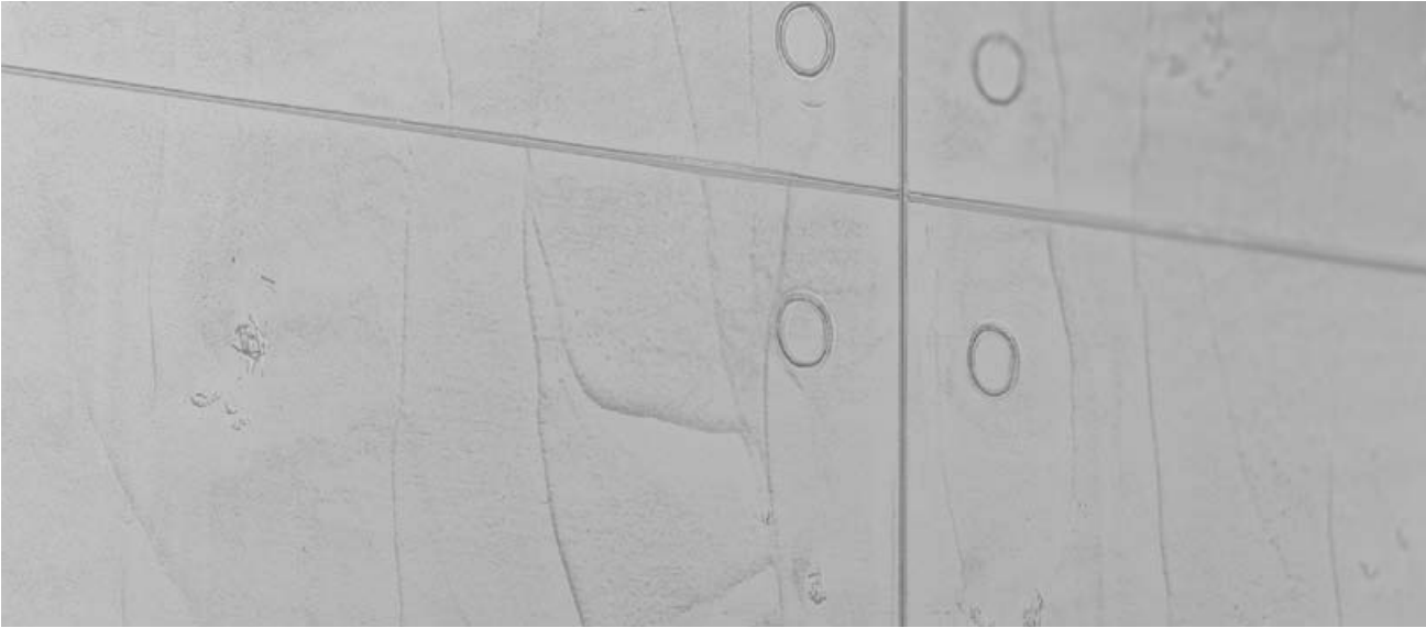
Struktura: Concrete Slab III Odstín: Chicago Grey Dvouvrstvá struktura. Struktura s imitací stop po bednění se vytváří ve druhé silnější vrstvě pomocí silnostěnné trubky či kolene, dlouhé latě a zaobleného dláta. Následně se dotváří struktura nezhuťněného betonu pomocí širokého tvrdého štětce.
