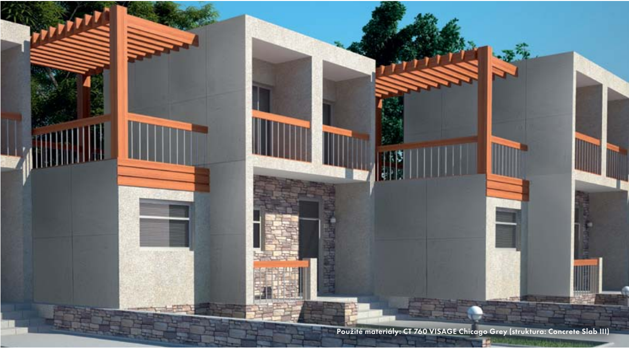
Struktura: Concrete Slab III Odstín: Chicago Grey Dvouvrstvá struktura. Struktura s imitací stop po bednění se vytváří ve druhé silnější vrstvě pomocí silnostěnné trubky či kolene, dlouhé latě a zaobleného dláta. Následně se dotváří struktura nezhuťněného betonu pomocí širokého tvrdého štětce.
