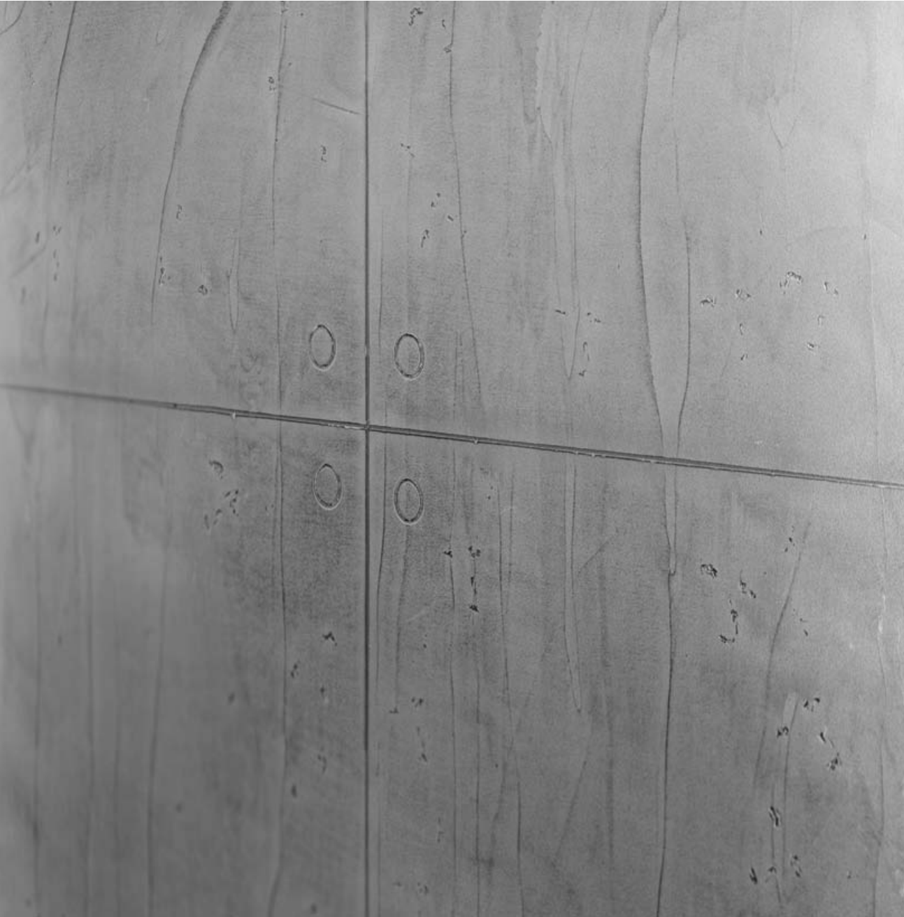
Struktura: Concrete Slab II Odstín: Tokyo Graphite Dvouvrstvá struktura. Struktura s imitací stop po bednění se vytváří ve druhé silnější vrstvě pomocí silnostěnné trubky či kolene, dlouhé latě a zaobleného dláta. Následně se dotváří struktura nezhuťněného betonu pomocí pomačkaného kusu papíru.
