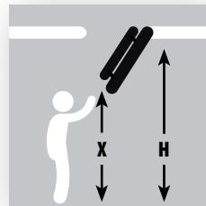
**i** Schody je možné vybavit odlehčujícím mechanismem LX, díky kterému je lze pohodlně ovládat pomocí ovládací tyče.
