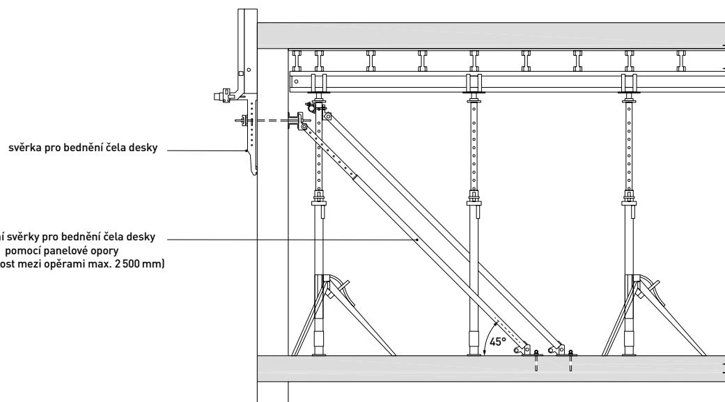
Diagonální směrové vzpěry pro zapření panelů (panelové opery) musí být ukotveny ke svérce pro bednění čela stropních desek ve vzdálenosti max. 2500 mm a u ostění otvorů.
