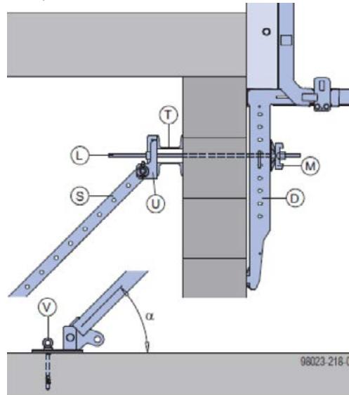
Tato varianta vyžaduje kotvení na vnitřní straně, například směrovou vzpěrou pro zapření panelů.
