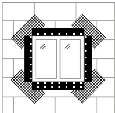
Nejprve připevněte na připravenou plochu správně všechny nárožní a okenní profily. Aby se zabránilo praskání následujících vrstev, aplikujte u každého rohu okna i dveří tkaninu v diagonálních pásech o rozměrech  $30 \times 50$  cm.
