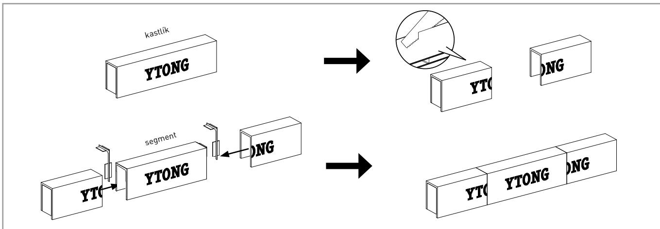
Při potřebě osazení žaluzií do otvorů větších šírek než 3 m lze použít kombinaci Ytong kastlíku a segmentu. Tyto se mezi sebou spojují přiloženými spojkami. Výsledné délky kastlíku je možné dosáhnout řezáním např. ruční pilkou na dřevo a železo.
