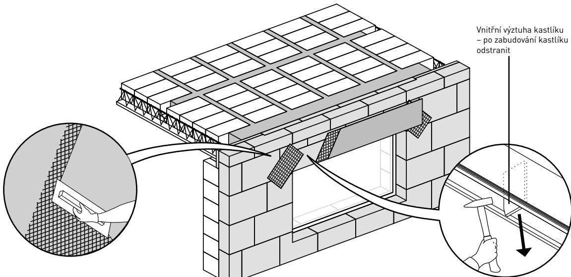
Povrchová úprava musí být provedená v souladu s údaji uvedenými v produktovém listu Žaluziové kastlíky a dodržením pokynů pro zhotovení zateplovacích systémů ETICS.
