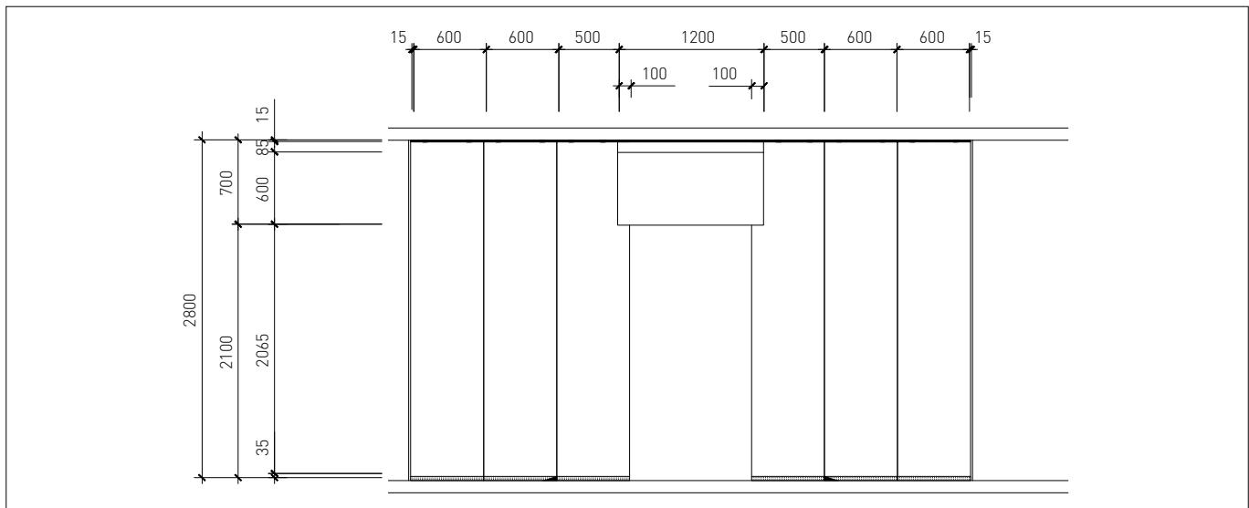
Druhou možností montáže nadpraží je usazení do sedla. Panely pro nadpraží se usazují do zárezu (sedla), které se připraví na míru na stavbě. Minimální uložení je 100 mm. Obě vzniklé spáry nad dveřním otvorem jsou lepené a přetáhnou se výztužnou tkaninou.
