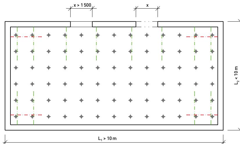
Poloha zavětrování stropní podpěry – půdorysné rozmístění:
