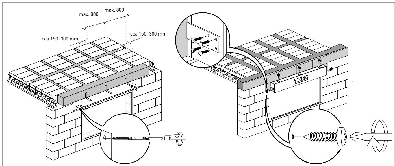
U dodatečně zateplené stěny se kastlík montuje na stěnu před zhotovením zateplení a po osazení oken. V tomto případě se přiložené L konzoly montují na kastlík podle potřeby jeho fixace na zdivo. Doporučujeme kastlík osadit tak, aby jeho přední desku bylo možno ještě překrýt vrstvou tepelného izolantu o tloušťce cca 20 mm, ale maximálně tak, aby lícovala s povrchem budoucího tepelného izolantu.
