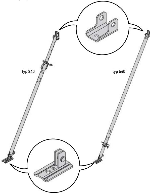
Panelové opory je třeba kotvit do nosného podkladu podle pokynů společnosti Doka přes spodní patku.
