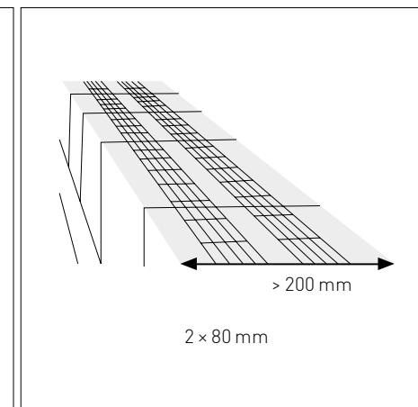
Nenáročné, rychlé a pohodlné řešení výztuže parapetu. Na vyztužení parapetního zdíva můžeme použít také Ytfor výztužný pás. Pás položíme na zdívo a zednickou lžící naneseeme celoplošně Ytong zdící maltu.
