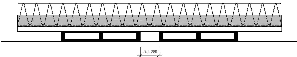
Skladování překladu musí být vždy na 2 dřevěných paletách vzdálených od sebe 240–280 mm. Překlady je zakázáno vrstvit. Ukládají se zásadně pouze v jedné vrstvě na zpevněné vodorovné ploše.
