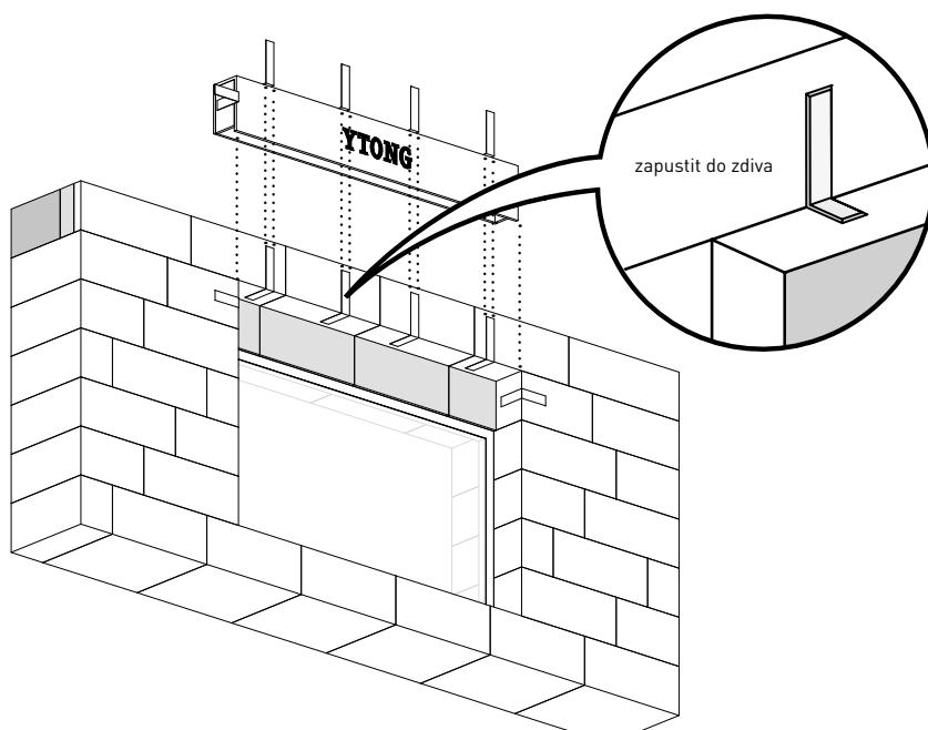
Druhý způsob je dodatečná montáž kastlíku do jednovrstvého zdiva. V tom případě osazujeme kastlík do vynechaného prostoru v nadpraží okna. Způsob osazení a povrchové úpravy je obdobný jako v předchozím případě. Při osazování dbáme vždy na pevnou fixaci kastlíku ke zdivu, aby nedošlo při manipulaci se žaluziemi k jeho pohybu a tím k následným estetickým poškozením vnější omítky.
