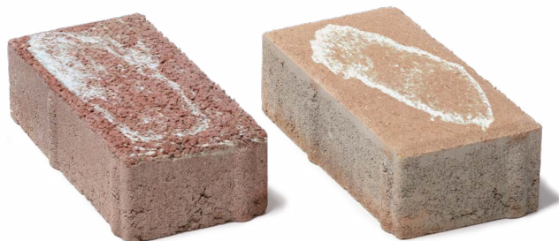
Dlažba s výkvětem
