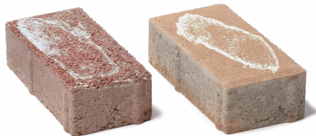
Dlažba s výkvětem
