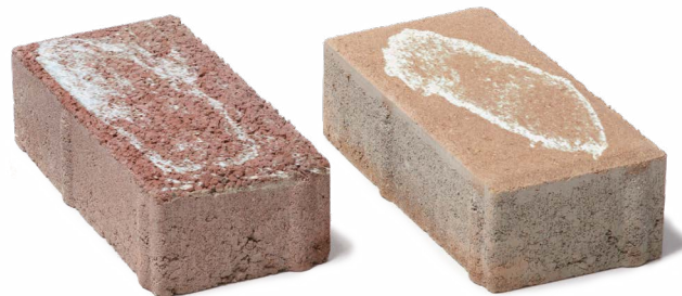
Dlažba s výkvětem
