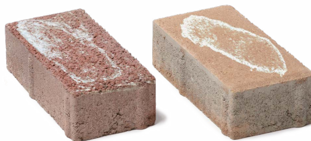
Dlažba s výkvětem
