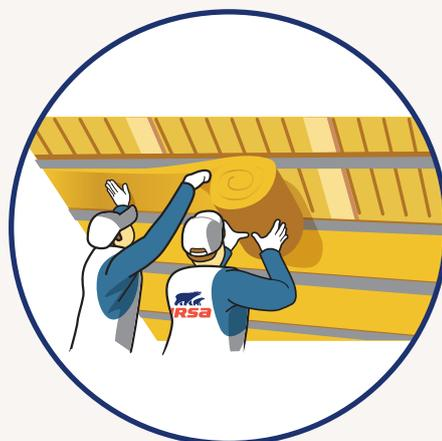
Aplikace minerální izolace URSA DF 38 do příčného kovového roštu upevněného na krokve, jako druhá tepelně izolační vrstva. Izolaci vkládáme lehkým vtlačáním po celé délce roštu. Dbejte stejných zásad jako v předešlém aplikačním kroku.
