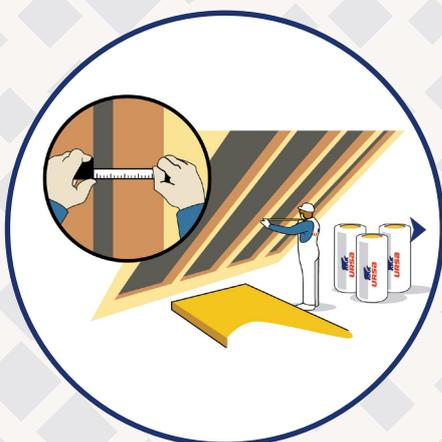
Změříme si šířku rozteče krokví. Pro zajištění lepší fixace minerální izolace URSA DF 38 mezi krokveři přidáme k naměřenému rozměru ještě 2 cm.
