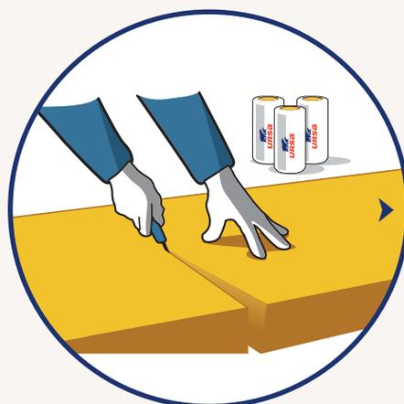
Odřízneme naměřenou část minerální izolace URSA DF 38. Řez provádíme podél přitlačné lišty (část OSB desky, kovový profil apod.) speciálním nožem URSA určeným k řezání izolace.
